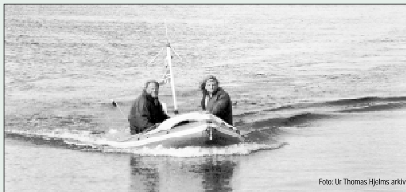
Far och son i en Avon 310, en ca 3 m lång (kort) gummibåt med fast plastbotten.
